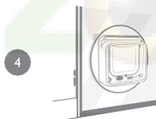
Desde el interior de la casa introduzca el túnel en el cristal, asegurándose de que la gatera esté posicionada en el centro del agujero. Presione con firmeza en la gatera y el adaptador de montaje, de tal forma que el sellante se pegue contra el cristal. Recuerde que el logo SureFlap debe estar dentro de la casa.
