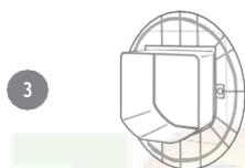
Coloque uno de los adaptadores de montaje (no importa cual) sobre el túnel de la gatera de tal forma que la parte con el sellante está orientada hacia fuera y no est en contacto con ninguna superficie.
