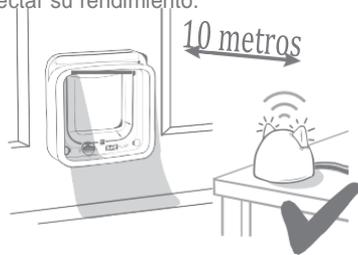
Intente colocar el concentrador en el campo visual de la gatera y a máximo 10 metros de separación.
