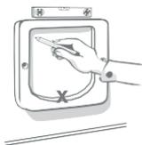
Fije el marco exterior a la puerta usando la marca, hecha para la altura de la barriga de su gato, **para alinear el borde inferior del agujero**. Use un nivel para asegurarse de que el marco está nivelado y recorra los bordes internos del marco con un lápiz afilado.
