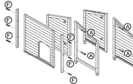
2. Una el panel frontal y trasero con el lateral derecho del panel (8). Después atornille el panel lateral izquierdo así como el panel central. Inserte el suelo.
