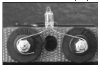
Luce di prova collegata alle sonde del ricevitore
